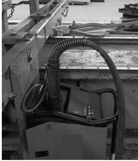
Fotoğraf-7 Hatalı torç formu
