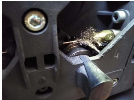
Fotoğraf-3 Baskı ayarının fazla olması sonucu telin yüzeyinden talaş kalkabilir.
