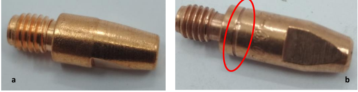
Fotoğraf-8 Standart (a) ve Zr Alaşımlı (b) Kontak Meme
