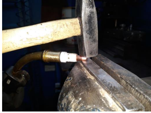
Fotoğraf-10 Kontak meme kesinlikle çekiçle dövülerek kullanılmamalıdır!
